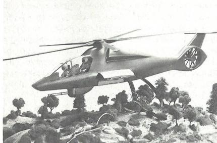
Unser Illustratorbild zeigt den Entwurf von Boeing/Sikorsky. Interessante Details sind dabei die in einem Rumpfwaflenschacht untergebrachte Lenkflugkörperbewaffnung, die aus zwei Mann bestehende Besatzung in Tandemanordnung, das T-förmige Leitwerk mit einem ummantelten Heckrotor sowie die vollständig in Verbundwerkstoffen ausgelegte Zelle. ka
