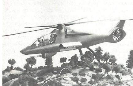
Unser Illustratordbild zeigt den Entwurf von Boeing/Sikorsky. Interessante Details sind dabei die in einem Rumpfwaflenschacht untergebrachte Lenkflugkörperbewaffnung, die aus zwei Mann bestehende Besatzung in Tandemanordnung, das T-förmige Leitwerk mit einem ummantelten Heckrotor sowie die vollständig in Verbundwerkstoffen ausgelegte Zelle. ka
