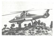
Unser Illustratorbild zeigt den Entwurf von Boeing/ Sikorsky. Interessante Details sind dabei die in einem Rumpfwaffenschacht untergebrachte Lenkflugkörperbewaffnung, die aus zwei Mann bestehende Besatzung in Tandemanordnung, das T-förmige Leitwerk mit einem ummantelten Heckrotor sowie die vollständig in Verbundwerkstoffen ausgelegte Zelle.
