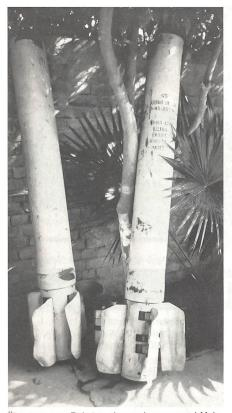
Überreste von Raketen eines schweren sowj Mehrfachraketenwerfers, möglicherweise des BM-22.
