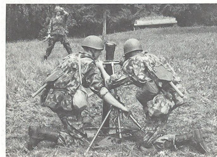
Der Werfer wird unter Zuhilfenahme eines Senkbleis eingerichtet.
