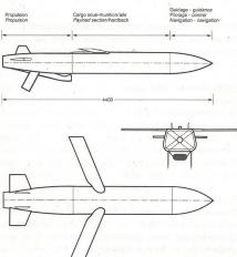
APACHE : Arme Propulsée A CHarge Ejectable
