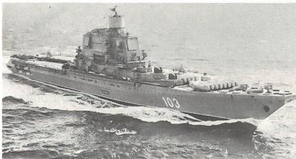
Das Bild zeigt den neuesten sowjetischen Flugzeugträger «Baku» auf seiner Verlegefahrt vom Mittelmeer zur Nordflotte im Dezember 1988. Gut erkennbar sind die ungewöhnlich kahlen Aufbauten. Mit dem Einbau der flächenartigen Radars auf allen vier Seiten der Insel sind die traditionellen rotierenden Antennen weitgehend überflüssig geworden. Dieses Prinzip ist seinerzeit erstmals auf den Lenkwaffenkreuzern der «Ticonderoga»-Klasse der US Navy angewendet worden. (RAF photo).
