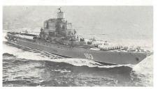
Das Bild zeigt den neuesten sowjetischen Flugzeugträger «Baku» auf seiner Verlegefahrt vom Mittelmeer zur Nordflotte im Dezember 1988. Gut erkennbar sind die ungewöhnlich kahlen Aufbauten. Mit dem Einbau der flächenartigen Radars auf allen vier Seiten der Insel sind die traditionellen rotierenden Antennen weitgehend überflüssig geworden. Dieses Prinzip ist seinerzeit erstmals auf den Lenkwaffenkreuzern der «Ticonderoga»-Klasse der US Navy angewendet worden. (RAF photo).
