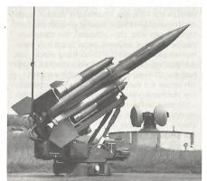
Fliegerabwehrlenkwaffe BL-64 Bloodhound. Die Bloodhound werden aus ortsfesten Stellungen abgeschossen. Sie ermöglichen die Bekämpfung von Luftzielen in grossen Höhen und auf grosse Entfernung mit hervorragender Wirkung. Die Feuereinheiten bestehen aus Einsatzstelle, Beleuchtungsradar und Werfern.
