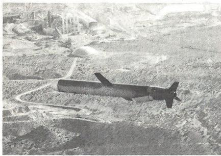
einem 450-kg-Bullpup-Gefechtskopf bestückte Version mit einer Reichweite von 463 km im Truppendienst. Dies vergrößert die bisherigen Bekämpfungsradien von Über- und Unterwassereinheiten beim Gefecht mit feindlichen Marinestreitkräften um ein Vielfaches auf etwa 450 km, was eine Angleichung an die Leistung der modernsten sowjetischen Seeziel-Marschflugkörper bedeutet.
