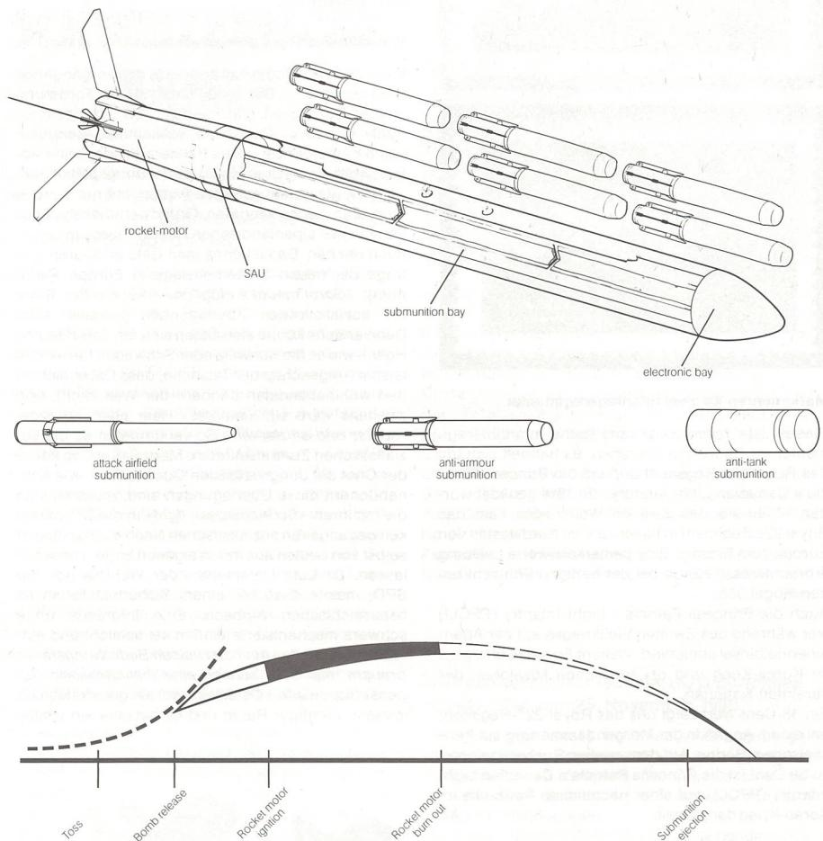
Für den Einsatz ab Mitte der 90er Jahre entwickelt Thomson Brandt Armements eine CASCAD Mk.2 genannte raketenunterstützte Dispenserwaffe für den Luft/Boden-Einsatz aus einer Abstandposition bis zu 10 km. Der auf unserer Foto abgebildete Dispenser eignet sich als Träger verschiedener Submunitionstypen, wie zum Beispiel Pistenbrechbomben, projek-
