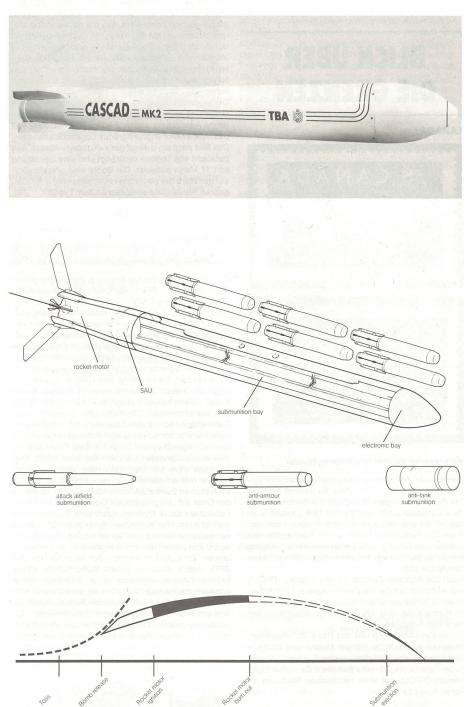
Für den Einsatz ab Mitte der 90er Jahre entwickelt Thomson Brandt Armements eine CASCAD Mk.2 genannte raketenunterstützte Dispenserwaffe für den Luft/Boden-Einsatz aus einer Abstandsposition bis zu 10 km. Der auf unserer Foto abgebildete Dispenser eignet sich als Träger verschiedener Submunitionstypen, wie zum Beispiel Pistenbrechbomben, projek-
