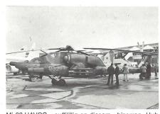
Mi-28 HAVOC – auffällig an diesem «bizarren» Hubschrauber ist die Anordnung der Bugsensoren und die kleinen Cockpits. Nicht verwechseln mit AH-64 APACHE, AH-1 HUEY COBRA oder Mi-24 HIND.
