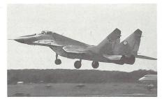
MiG-29 FULCRUM – die Maschine ist gegenüber der Su-27 viel kompakter gebaut, hat keine Lenkwaffenschienen an den Flügelspitzen. Der Knick in der Vorderkante des Seitenleitwerks ist ebenfalls zu erkennen
