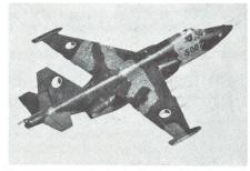
Su-25 FROGFOOT – kastenförmiger Rumpf, gerade Flügel mit Behältern an den Flügelspitzen und unter den hoch angesetzten Flügeln aussen an den Rumpfseiten montierte Triebwerke. Nicht verwechseln mit ALPHA JET und HARRIER.
