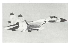
Su-27 FLANKER – schön zu erkennen die lange «Nase» mit dem grossen Radom, die weit hinten angesetzten Flügel sowie der Konus zwischen den beiden Triebwerksauslässen.
