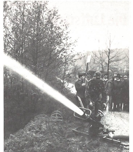
Wasserwerfer 83 im Einsatz (Wassermenge 2000 l/min mit einer Wurfweite von 60 bis 70 m.)
