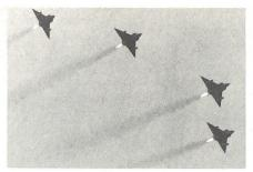
Vier Mirage IIIS mit eingeschalteten SEPR-Zusatztriebwerken
