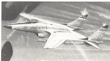
Generation prüft man zurzeit verschiedene Antriebskonzepte, darunter Schubvektorsteuerung mit Nebenstromverbrennung und Hubdüsen mit Vertikabrennkammern. Unsere beiden Illustratorträger veranschaulichen Entwurfstudien von British Aerospace für je ein ASTOVL-Luftkampf- und Luftangriffsflugzeug. ka
