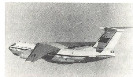
sel-/Fangrichter-Luftbetankungssystem. Dieses setzt sich aus zwei Unterflügel- und einem seitlich am hinteren Teil des Rumpfs (Bild) angebrachten Betankungsbehältern mit ausfahrbaren Rüsseln zusammen. Foto 334 Sq Royal Norwegian Airforce. (ADLG 8/88: Il-78 MIDAS)
