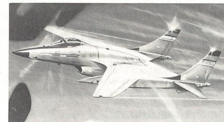
Generation prüft man zurzeit verschiedene Antriebskonzepte, darunter Schubvektorsteuerung mit Nebenstromverbrennung und Hubdüsen mit Vertikabrennkammern. Unsere beiden Illustratorbilder veranschaulichen Entwurfstudien von British Aerospace für je ein ASTOVL-Luftkampf- und Luftangriffsflugzeug.
