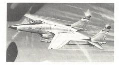
Generation prüft man zurzeit verschiedene Antriebskonzepte, darunter Schubvektorsteuerung mit Nebenstromverbrennung und Hubdüsen mit Vertikalbrennkammern. Unsere beiden Illustratorbilder veranschaulichen Entwurfsstudien von British Aerospace für je ein ASTOVL-Luftkampf- und Luftangriffsflugzeug.
