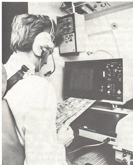
Linescan 4000 arbeitet Tag und Nacht bei schlechter Sicht. Die Bilder können in Echtzeit entweder an Bord der Maschine oder in einer Bodenstation dargestellt werden. (BN)
