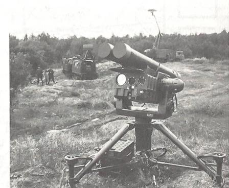
men. Mit dem vom Feuerleitfahrzeug abgestellt zum Einsatz gelangenden, fernbedienten Zweifachwerfer lassen sich sowohl Lenkwaffen RBS70 der Modelle Mk.1 als auch Mk.2 verschießen. Die letztere Version erreicht eine Höchstschnellschweite von bis zu 7 km. ka
