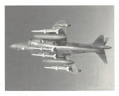
last. Bewaffnet mit der Seeziellenkwaffe Sea Eagle und dem Antiradarlenkflugkörper ALARM soll der trägergestützte Sea Harrier auch für die Seezielbekämpfung zum Einsatz gelangen. Unsere folgende Zeichnung veranschaulicht zwei typische Angriffsprofile für je eine Luft/Luft- und Luft/Schiff-Mission (ADLG 5/89: Harrier GR.5)
