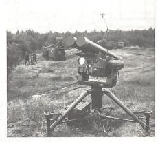
men. Mit dem vom Feuerleitfahrzeug abgestellt zum Einsatz gelangenden, fernbedienten Zweifachwerfer lassen sich sowohl Lenkwaffen RBS70 der Modelle Mk.1 als auch Mk.2 verschiessen. Die letztere Version erreicht eine Höchstschussweite von bis zu 7 km. ka
