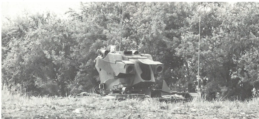
Von der Vorderseite darf im Zeitpunkt des Abschusses der Lenk Waffen, vom Panzerjäger nurmehr der Werferturm mit dem Lenkwaffensystem TOW sichtbar sein.
