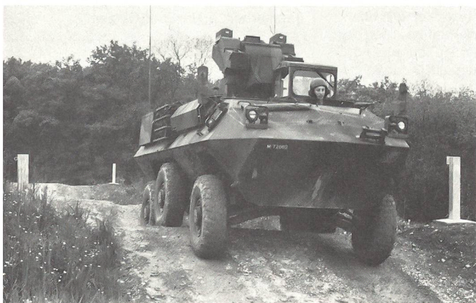
Die Geländegängigkeit des Piranhas ist verblüffend: mit grosser Geschwindigkeit meistert er problemlos auch grössere Bodennebenheiten. Auf der Fahrpiste des Waffenplatzes Chamblon können die Fahrer extreme Geländeabschnitte befahren. Der Piranha verträgt auch seitliche Neigungen von 35°.
