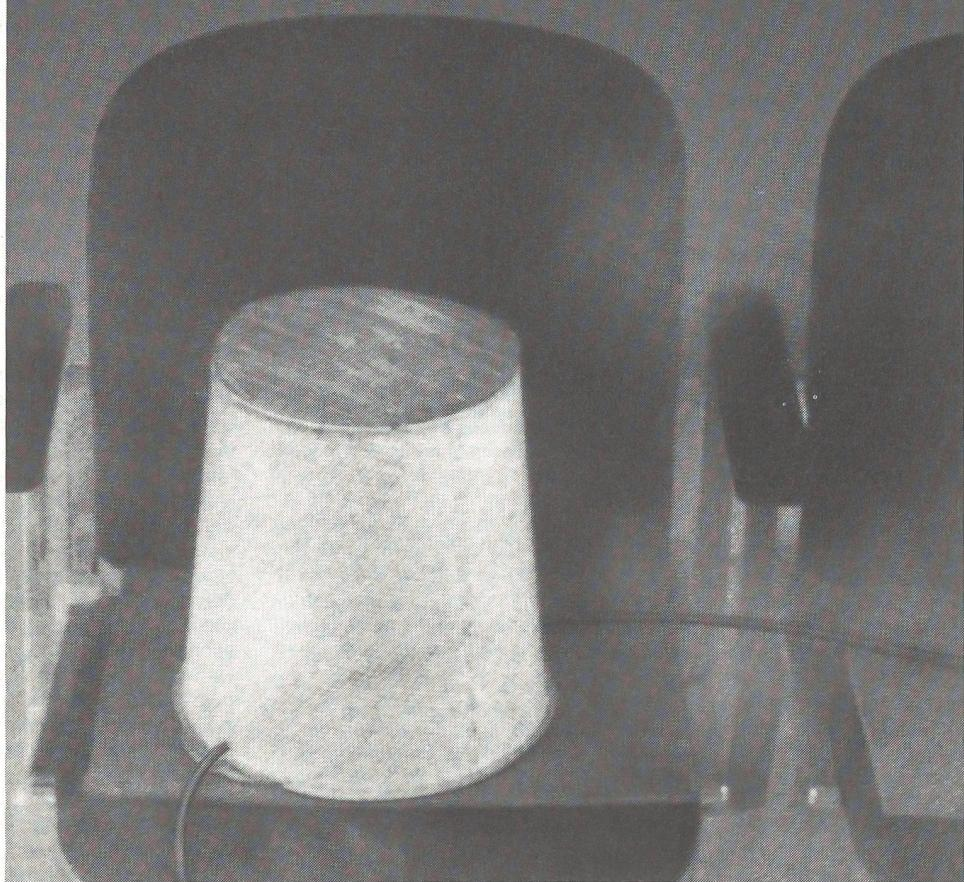
**D**as ist kein Topf, sondern Teil einer Versuchsanordnung, mit deren Hilfe die Wärmeabgabe von Menschen simuliert wird. Mit solchen Modellversuchen löst Sulzer die Aufgaben, die bei der Belüftung grosser Säle gestellt werden, und verhindert so, dass Theater- und Konzertbesucher kalte Füsse, Studenten heisse Köpfe und Redner trockene Kehlen bekommen.
