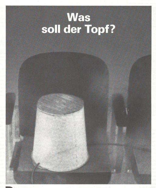
Das ist kein Topf, sondern Teil einer Versuchsanordnung, mit deren Hilfe die Wärmeabgabe von Menschen simuliert wird. Mit solchen Modellversuchen löst Sulzer die Aufgaben, die bei der Belüftung grosser Säle gestellt werden, und verhindert so, dass Theater- und Konzertbesucher kalte Füsse, Studenten heisse Köpfe und Redner trockene Kehlen bekommen.
