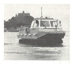
Wüstensand und sogar Schwimmsand. Dabei erreicht es auf Strassen Geschwindigkeiten bis 50 km/h.
