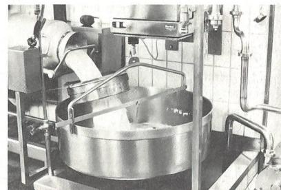
Auch Gewerbe und Industrie können Energie sparen. In dieser Käserei zum Beispiel liefert eine Anlage zur Wärmerückgewinnung einen grossen Teil der benötigten Wärme: Damit wird die Wohnung geheizt und ein grosser Teil der Wärme für die Aufheizung des Kupferkessels auf 55 °C abgedeckt. Unter dem Strich werden hier jährlich 12 000 Liter Heizöl eingespart; den Kosten und der Umwelt zuliebe.
