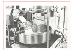
Auch Gewerbe und Industrie können Energie sparen. In dieser Käserei zum Beispiel liefert eine Anlage zur Wärmerückgewinnung einen grossen Teil der benötigten Wärme: Damit wird die Wohnung geheizt und ein grosser Teil der Wärme für die Aufheizung des Kupferkessels auf 55°C abgedeckt. Unter dem Strich werden hier jährlich 12000 Liter Heizöl eingespart; den Kosten und der Umwelt zuliebe.
