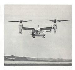
Enden schwenkbare Rotoren angebracht sind. Diese Rotoren ermöglichen bei vertikaler Einstellung den V/STOL-Einsatz und in gekippter Lage den Horizontalflug eines Flächenflugzeugs. Dadurch lässt sich gegenüber den heutigen Hubschraubern eine etwa doppelt so hohe Geschwindigkeit und Reichweite erzielen. (ADLG 2/89: V-22 Osprey).
