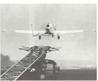
Der «Ranger» wird ab einer Startrampe in die Luft katapultiert.
