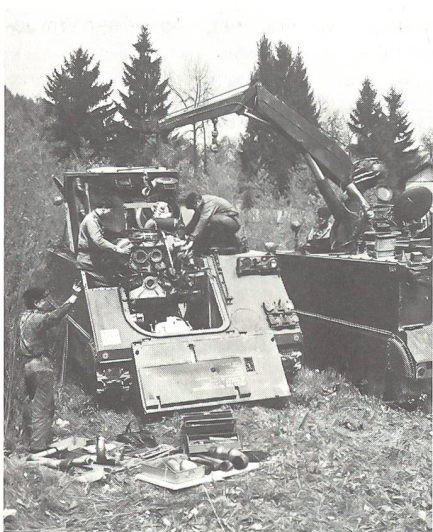
Die Panzermechaniker beim Ausbau eines Motors.
