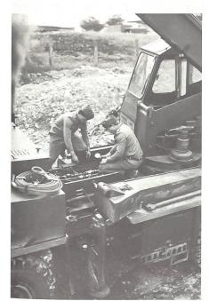
Baumaschinenmechaniker bei den Einstellarbeiten am Motor.
