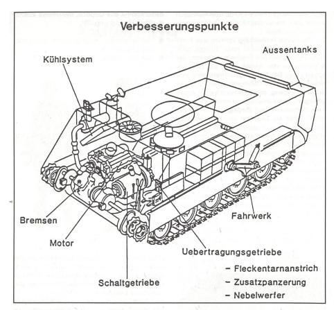
steigerung werden die Fahrzeuge erfasst, welche zusammen mit dem Panzer 87 Leopard eingesetzt werden.
