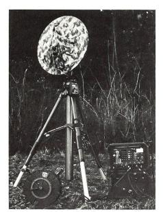
Mit der neuen Richtstrahlstation R-915 werden gebündelte Funkverbindungen (bis 60 Kanäle gleichzeitig) über hindernisfreie Entfernungen bis rund 120 km in einwandfreier Qualität sichergestellt.
