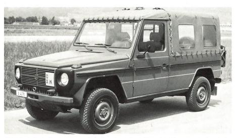
4100 geländegängige Personenwagen «Puch» G werden als Ersatz für veraltete Fahrzeuge gekauft, so der Antrag. Sie ersetzen mit verschiedenen Aufbauten die Unimog 4×41 Tonnen, die 4×4 Haflinger und den Jeep.
