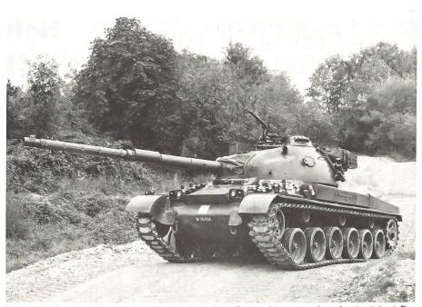
Von den 390 Panzern 68 werden die Hälfte, nämlich 195, als Gegenschlagspanzer kampfwertgesteigert. Das heisst, dass vor allem die Ziel- und Feuerleitanlage verbessert wird. Ein feindlicher Panzer wird aus der eigenen Bewegung heraus sehr genau bekämpft werden können.
