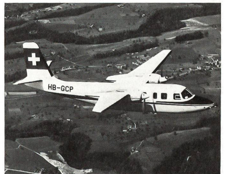
Das Vermessungsflugzeug der Landestopographie fliegt für die Nachführung der Landeskarten ca 3500 m über Boden.
