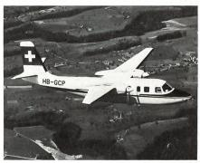
Das Vermessungsflugzeug der Landestopographie fliegt für die Nachführung der Landeskarten ca 3500 m über Boden.
