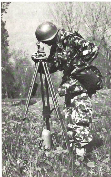
Die Batterie wird mit Kleintheodoliten eingerichtet.
