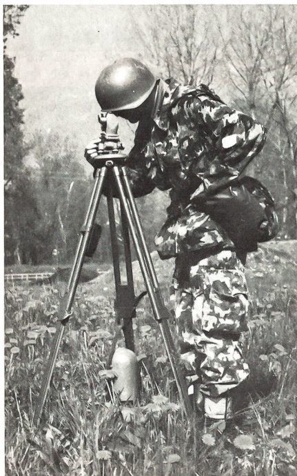
Die Batterie wird mit Kleintheodoliten eingerichtet.
