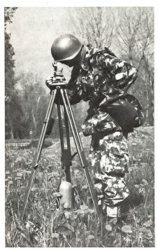
Die Batterie wird mit Kleintheodoliten eingerichtet.
