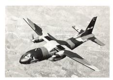
behelfsmässig vorbereiteten Pisten offeriert sie mit einer Nutzlast von 2000 kg einen Aktionsradius von 2000 km. Bereits werden auch bewaffnete Versionen für die Seeüberwachung und die U-Boot-Bekämpfung studiert. Die folgenden Zeichnungen veranschaulichen vier mögliche Missionsprofile der CN.235 in der Kampfzonentransport- und U-Boot-Jagd-Version. ka
