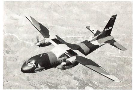
behelfsmässig vorbereiteten Pisten offeriert sie mit einer Nutzlast von 2000 kg einen Aktionsradius von 2000 km. Bereits werden auch bewaffnete Versionen für die Seeüberwachung und die U-Boot-Bekämpfung studiert. Die folgenden Zeichnungen veranschaulichen vier mögliche Missionsprofile der CN.235 in der Kampfzonentransport- und der U-Boot-Jagd-Version. ka
