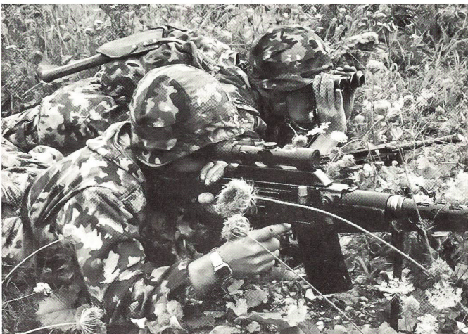
Scharfschütze mit Zielfernrohr. Sturmgewehr 57 mit aufgesetztem Zielfernrohr. Praktische Schussweite bis 500 m.
