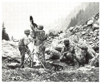
12-cm-Minenwerfer in Feuerstellung. Gewicht 239 kg, Schussweite 7,5 km, 3–4 Mann Bedienung, Feuergeschwindigkeit ca 6 Schuss/Minute. Munition:
