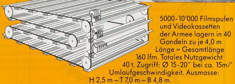
5000-10'000 Filmspulen und Videokassetten der Armee lagern in 40 Gondeln zu je 4,0 m Länge = Gesamtlänge 160 lfm. Totales Nutzgewicht 40 t. Zugriff: Ø 15-20" bei ca. 15"/ Umlaufgeschwindigkeit. Ausmasse: H 2,5 m – T 7,0 m – B 4,8 m.
