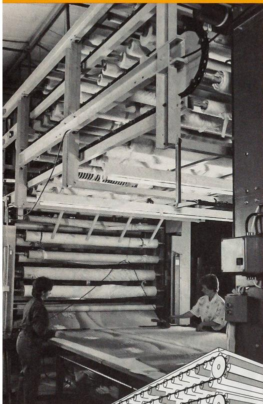
Über 100 Rollen Stoff in unterschiedlichsten Dessins lagern hier direkt neben und über dem Arbeitsplatz: Superschneller Zugriff! Ausmasse: H 4,2 m – L 5,9 m – B 2,8 m. Gesamtzuladung: 5 t.
