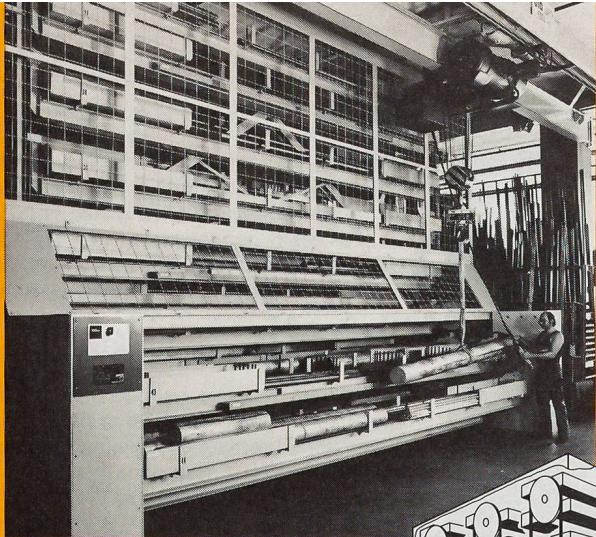
Zwischen Anlieferungsrampe und Sägeautomaten lagert in dieser Anlage 80 t Langgut (Stäbe, Rohre, Profile, Stangen) in 48 Gondelkassetten von 6,3 m Nutzlänge. Ausmasse: H 5,45 m – T 6,05 m – B 7,66 m. Zugriff: Ø 60-90". 1seitige Hebekraft: 12 t Unlast bei ungleichmässiger Beladung.
