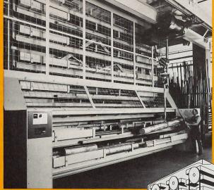
Zwischen Anlieferungsrampe und Sägeautomaten lagert in dieser Anlage 80 t Langgut (Stäbe, Rohre, Profile, Stangen) in 48 Gondelkassetten von 6,3 m Nutzlänge. Ausmasse: H 5,45 m – T 6,05 m – B 7,66 m. Zugriff: Ø 60-90". 1 seitige
