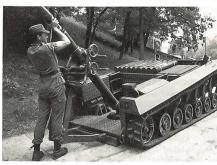
Zur Herstellung der Feuerbereitschaft wird das Fahrzeugheck des VPX 40 M oder RPX 40 M auf den Boden abgesenkt und dient dann als Bodenplatte des eingebauten Mörsers. Beide Fahrzeuge sollen später eine Ladehilfe erhalten.
