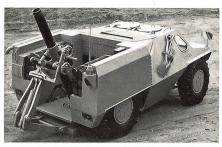
Der hochmobile Radpanzer RPX 40 M ist mit einer gepanzerten Kabine ausgerüstet, die über zwei Luken im Dach und eine einzelne Seitentür vorne links zugänglich ist. Für die Bedienung des Mörsers 120 RT reichen vier Mann aus, doch ist normalerweise ein Begleitfahrzeug erforderlich, um den grössten Teil der Munitionsausstattung zu transportieren.
