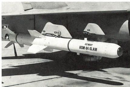
position ausgelegten Lenkwaffe und sicherte sich eine Option für die Fertigung einer 1. Serie von 290 Flugkörpern. Die auf unserer Foto am Unterflügelträger einer F/A-18 Hornet gezeigte «Standoff Land Attack Missile» unterscheidet sich von der AGM-84 Harpoon durch
