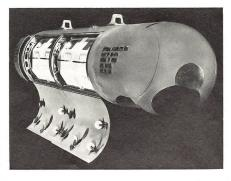
flugzeugen. Charakteristische Eigenschaften von Litening sind ferner auf Staffelebene auswechselbare Subsysteme (LRU), ein kardanisch gelagerter Sensorkopf mit der auf allen vier Achsen stabilisierten FLIR-Kamera MTIS sowie eine auf ein Datenbussystem nach MIL-STD-1553B passende Interface-Einheit. Litening-Gondeln aus der Serienfertigung könnten laut Herstellerinformationen bereits 12 bis 18 Monate nach Erhalt eines Erstauftrages an den Auftraggeber ausgeliefert werden.
