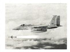
Luftzielrakete mittlerer Reichweite AIM-120A AM-RAAM repräsentiert die AIM-7 Sparrow neben der infrarotgesteuerten AIM-9 Sidewinder mit der Ausnahme des F-14 Tomcat (AIM-54 Phoenix) die Hauptbewaffnung aller US Allwetterabfang- und Luftüberlegenheitsjäger.
