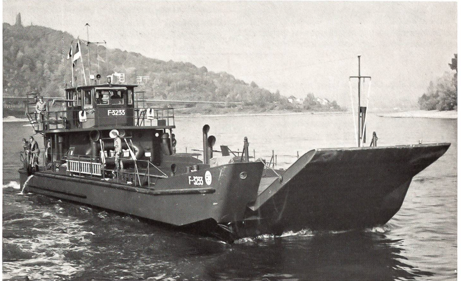
Flussfähren der TerrHeeres – hier vom Typ «Mannheim» – dienen dem Überwinden breiter Gewässer im rückwärtigen Gebiet.
