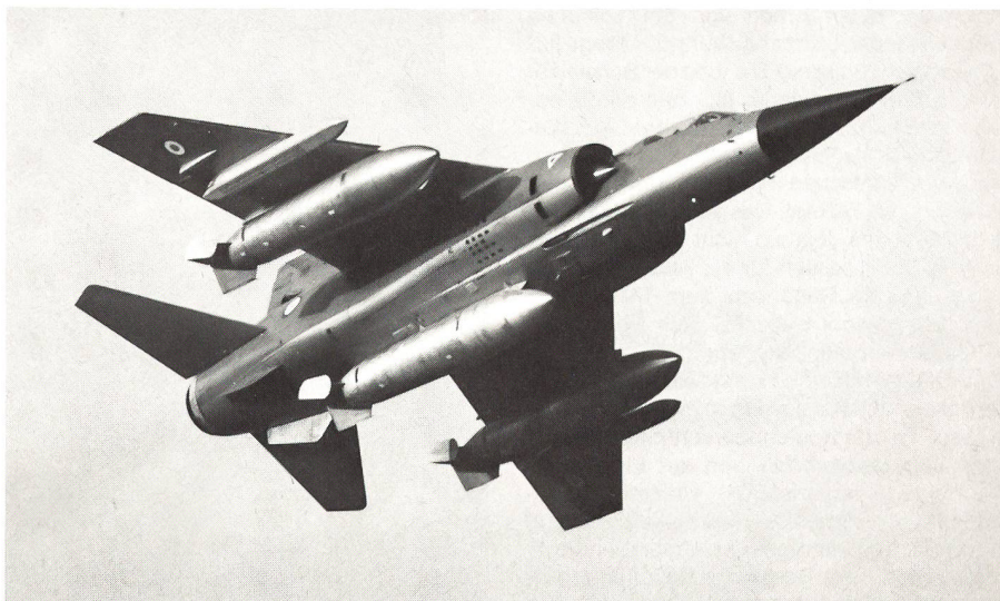
Bei der Mirage F1 kam man von der Deltaflügelkonstruktion weg.
