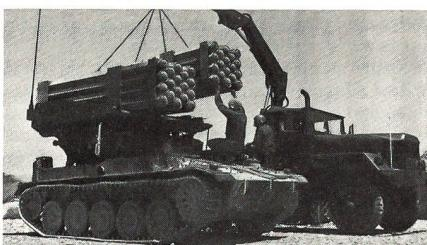
dige Aufmunitionierung ist in 10 Minuten zu bewältigen. Durch das Schiessen einer ersten Pilotrakete können mit dem Contraves Feuerleit- und Kontrollgerät die für ein Ziel notwendigen Wirkungselemente ermittelt werden.
