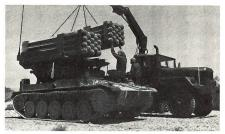
dige Aufmunitionierung ist in 10 Minuten zu bewältigen. Durch das Schiessen einer ersten Pilotrakete können mit dem Contraves Feuerleit- und Kontrollgerät die für ein Ziel notwendigen Wirkungselemente ermittelt werden.
