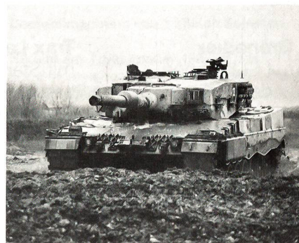
Mittels Frontalschuss durch die intelligente Bauweise kaum zu knacken. Und nur kleinste Erhebungen lassen die verwundbaren Kettenpartien schützend verschwinden.
