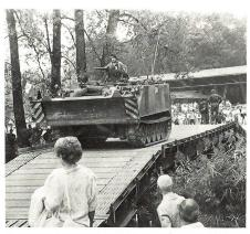
Kurze Zeit nach dem Einbau der Brücke 69 fährt der Geniepanzer 63 über das Wasserhindernis.
