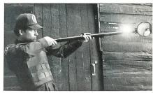
Für Einsätze bei Nacht kann eine Halogenleuchte mit einer Lichtstärke von 20 000 cd eingebaut werden. In Verbindung mit geeigneten Nachtsichtgeräten kann statt dessen auch ein IR-Scheinwerfer installiert werden. Der Strom für den Spiegelstellmechanismus und die Beobachtungsleuchte wird von fünf alkalischen Monozellen geliefert, die im Handgriff untergebracht werden. Das Gerät wird von Havis-Shields Equipment Corporation, 538 Davis Road, Willow Grove, PA 19090, USA, hergestellt.
