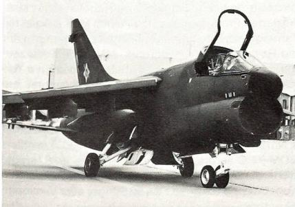
einen Vorwärtsicht-Infrarotbehälter am rumpfnahen rechten Unterflügellasträger und ein automatisches System für den Geländefolgeflug. Die von einer Mantelstromturbine Allison/Rolls Royce TF-41-A-1 Spey ohne Nachbrenner angetriebene A-7D Corsair II wird von den US Luftstreitkräften mit Schwergewicht für Luftnahunterstützungs- und Gefechtsfeldabriegelungs-Missionen eingesetzt. (ADLG 5/87: LANA) ka
