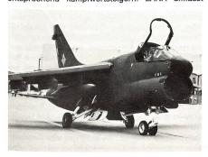
einen Vorwärtssicht-Infrarotbehälter am rumpfnahen rechten Unterflügellastträger und ein automatisches System für den Geländefolgeflug. Die von einer Mantelstromturbine Allison/Rolls Royce TF-41-A-1 Spey ohne Nachbrenner angetriebene A-7D Corsair II wird von den US Luftstreitkräften mit Schwergewicht für Luftnahunterstützungs- und Gefechtsfeldabriegelungs-Missionen eingesetzt. (ADLG 5/87: LANA) ka
