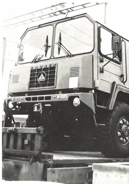
Lastwagen 10t, 6x6, «Saurer» nach dem Bahnverlad auf einen SBB-Flachwagen «KS». Die Sicherung der vorderen Räder mit Keilen fehlt noch.
