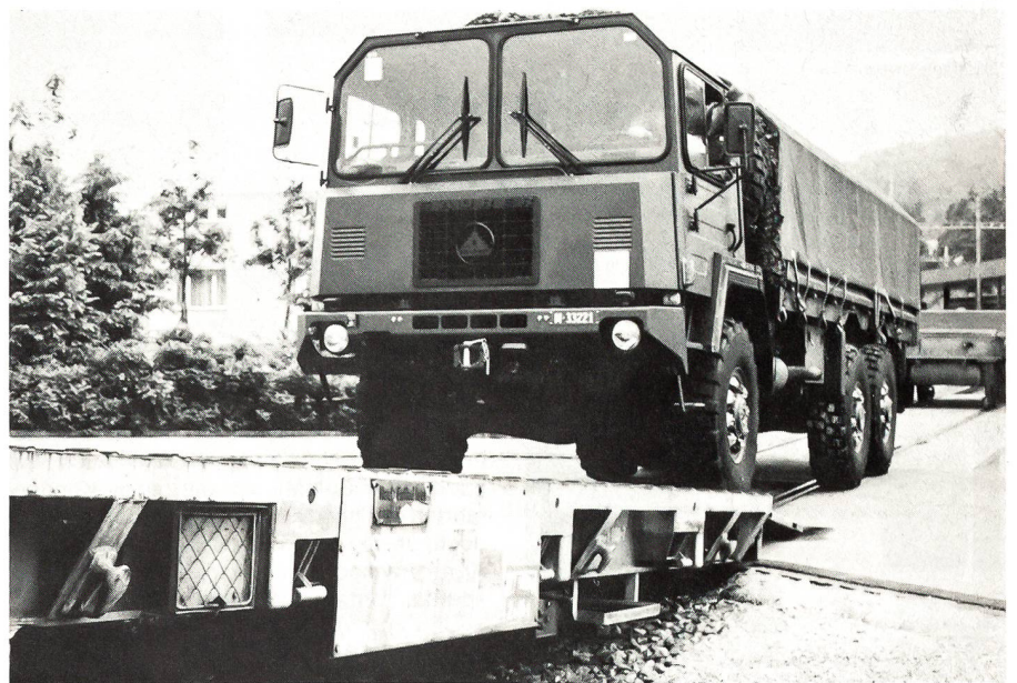
Bei den Vorführungen der Eib Betr Gr 3 wurde auch das Verladen mittels eines Rampenwagens «SMPS» durchgeführt. Das Bild zeigt die Auffahrt des Saurer-Lastwagens 10t, 6x6. Über den Rampenwagen können ganze Züge auf offener Strecke mit Fahrzeugen beladen werden.
