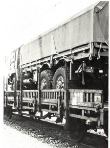
Lastwagen 10 t, 6×6, «Saurer» nach dem Bahnverlad auf einen SBB-Flachwagen «KS». Die Sicherung der vorderen Räder mit Keilen fehlt noch.
