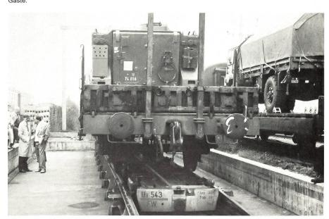
Ein auf einem Tiefladewagen der SBB verladener Schützenpanzer, auf Rollböcken vorbereitet zur Fahrt auf Schmalspur. Rechts im Bild ist die Arretierung mit einem neuen Metallkeil für Pneufahrzeuge erkennbar.
