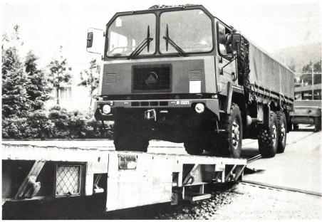
Bei den Vorführungen der Eisb Betr Gr 3 wurde auch das Verladen mittels eines Rampenwagens «SMPS» vorgeführt. Das Bild zeigt die Auffahrt des Saurer-Lastwagens 10 t, 6×6. Über den Rampenwagen können ganze Züge auf offener Strecke mit Fahrzeugen beladen werden.
