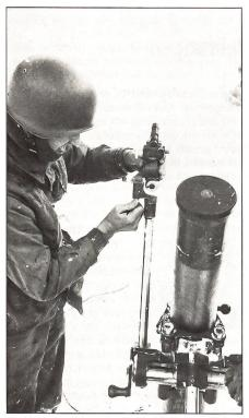
Ein Kanonier richtet den 12-cm-Minenwerfer 74 ein. Diese Waffe schiesst bis 7,5 km weit mit einer Schusskadenz von 6 Schuss/min.
