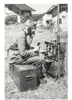
TL-BBC/SE-212, Verbindung Flugzeug-Erdtruppe sowie Kdo- und Fernüberwachungsverbindungen der Schweren Flab im Aktivdienst 1939–1945 Bild aus der Festschrift
