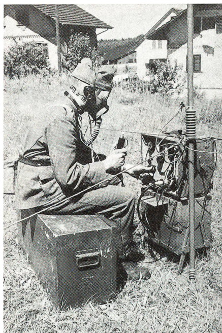
TL-BBC/SE-212, Verbindung Flugzeug-Erdtruppe sowie Kdo- und Fernüberwachungsverbindungen der Schweren Flab im Aktivdienst 1939–1945
