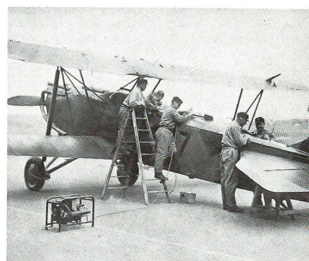
Abstimmen des FG-IV am Flugzeug C-V: Flieger-Rekrut Bolliger arbeitet in der RS 1938 am Antennen-Abstimmgerät (zweiter von rechts); ohne Kopfbedeckung im Beobachtersitz Kpl Lüthi Bild aus der Festschrift
