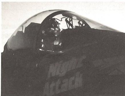
Rumpfbug eingerüsteter Vorwärtsichtinfrarotsensor für die Tiefflugnavigation und Zielsuche, eine Weitwinkel-Blickfelddarstellungseinheit, ein Mehrfarben-Multifunktionsdisplay sowie eine Nachtsichtbrille für den Piloten (Bild oben). (ADLG 11/87: Night Attack AV-8B Harrier II) ka
