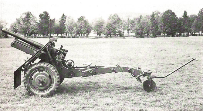
7,5 cm Mot Geb Kanone 38 L22 Prototyp
