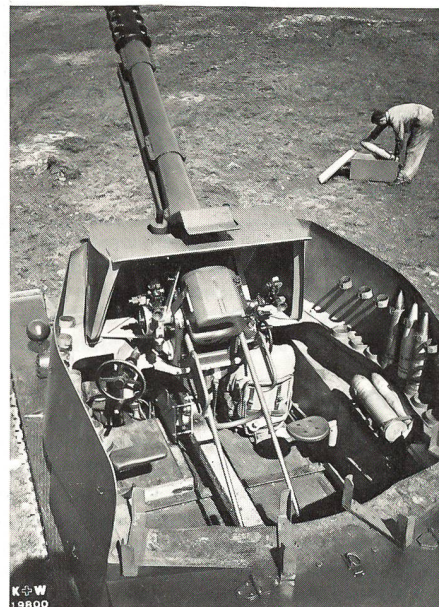
Nahkampfkanone 1, Chassis-Konstruktion aus Ersatzteilen des Panzerwagens 39 mit 10,5 cm b 42. Eigenentwicklung K+W während des Zweiten Weltkrieges.
