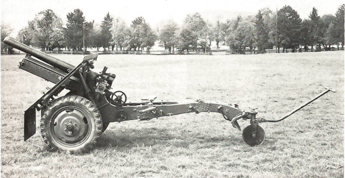
7,5 cm Mot Geb Kanone 38 L22 Prototyp
