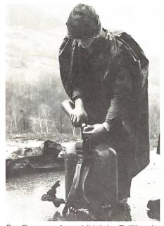
Der Flammenwerferspezialist beim Einfüllen des Stickstoffes, durch dessen Druck das Flammöl aus dem Flammrohr herausgepresst wird.
