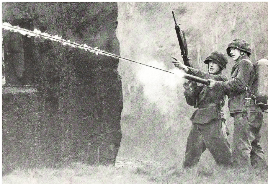
Der Flammenwerfer im Häuserkampf. Das als feiner Strahl durch das Flammrohr austretende Öl verwandelt das getroffene Ziel in ein flammendes Inferno.
