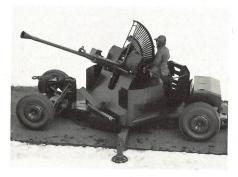
steigert. Die Munition wird mit Annäherungszündern ausgerüstet. Die kampfwertsteigernden Massnahmen werden im Rahmen der Hauptinstandsetzung mit 54 Fla von RDM in Rotterdam durchgeführt, nachdem sechs Geschütze von Bofors/Schweden auf den neuen Serienstand gebracht worden sind. Die Lebensdauer nach der Umrüstung ist auf weitere 20 Jahre geplant.
