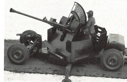
steigert. Die Munition wird mit Annäherungszündern ausgerüstet. Die kampfwertsteigernden Massnahmen werden im Rahmen der Hauptinstandsetzung mit 54 Fla von RDM in Rotterdam durchgeführt, nachdem sechs Geschütze von Bofors/Schweden auf den neuen Serienstand gebracht worden sind. Die Lebensdauer nach der Umrüstung ist auf weitere 20 Jahre geplant.
