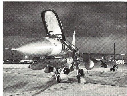
schlossen werden. Unsere obige Aufnahme zeigt eine mit dem Tiefflug-Navigations- und Kampfmittel-System LANTIRN ausgerüstete und mit zwei nachtkampftauglichen Luft/Boden-Lenkwaffen AGM-65D Maverick bewaffnete F-16 Fighting Falcon kurz vor dem Start zu einem Einsatzflug. (ADLG 7/88: AH 64/ATHS und ADLG 9/88: ATARS) ka
