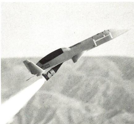
satzhöhen bis zu 13716 m. Das integrierte Trägheitsnavigationssystem wird im Fluge mit der Hilfe eines eingerüsteten Empfängers des satellitengestützten Navigationssystems Navstar/GPS aufdatiert. Die Bergung von Scarab erfolgt nach Beendigung der Mission mit der Hilfe von zwei Fallschirmen und eines Landekissensystems für die Dämpfung des Aufschlags am Boden. ka
