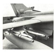
ohne Einschränkungen ab den heute bei den Einsatzstaffeln im Truppendienste stehenden Sidewinder-Werfern verschossen werden. Im Einsatze ermöglicht die auf unserem Foto an seitlichen Stummelauslegern einer Unterflügel-Laststation eines Tornados F.3 ADV mitgeführte AIM-132 ASRAAM die Bekämpfung von Luftzielen aus allen Richtungen, wobei im Kurvenkampf selbst hochmanövrierende Ziele abgefangen werden können.
