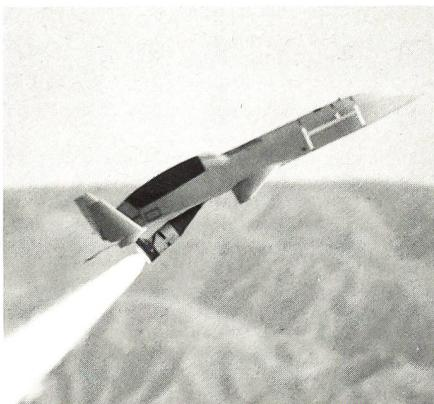
satzhöhen bis zu 13716 m. Das integrierte Trägheitsnavigationssystem wird im Fluge mit der Hilfe eines eingerüsteten Empfängers des satellitengestützten Navigationssystems Navstar/GPS aufdatiert. Die Bergung von Scarab erfolgt nach Beendigung der Mission mit der Hilfe von zwei Fallschirmen und eines Landekissensystems für die Dämpfung des Aufschlags am Boden. ka
