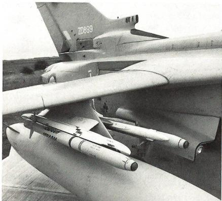
ohne Einschränkungen ab den heute bei den Einsatzstaffeln im Truppendienste stehenden Sidewinder-Werfern verschossen werden. Im Einsatz ermöglicht die auf unserem Foto am seitlichen Stummelauslegern einer Unterflügel-Laststation eines Tornados F.3 ADV mitgeführte AIM-132 ASRAAM die Bekämpfung von Luftzielen aus allen Richtungen, wobei im Kurvenkampf selbst hochmanövrierende Ziele abgefangen werden können. ka
