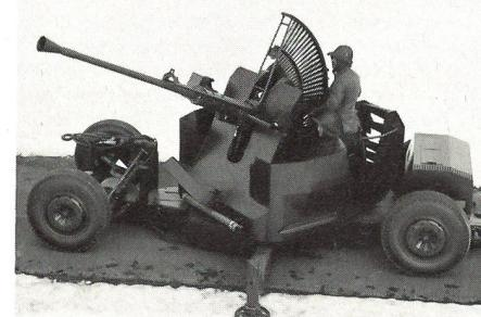
steigert. Die Munition wird mit Annäherungszündern ausgerüstet. Die kampfwertsteigernden Massnahmen werden im Rahmen der Hauptinstandsetzung mit 54 Fla von RDM in Rotterdam durchgeführt, nachdem sechs Geschütze von Bofors/Schweden auf den neuen Serienstand gebracht worden sind. Die Lebensdauer nach der Umrüstung ist auf weitere 20 Jahre geplant.
