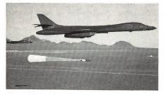
eine breite Palette von konventionellen Luft/Boden-Waffen mitführen. Unsere obige Foto zeigt einen von einem F-111 begleiteten B-1B beim Abwurf einer fallverzögerten Nuklearbombe des Typs B83. Die folgende Aufnahme veranschaulicht den Reihenwurf von 56 fallverzögerten 227-kg-Bomben Mk.82 (BSU-49) aus einer Höhe von 60 m bei einer Einsatzträger-Geschwindigkeit von Mach 0,8. (ADLG 4/87: B-1B) ka
