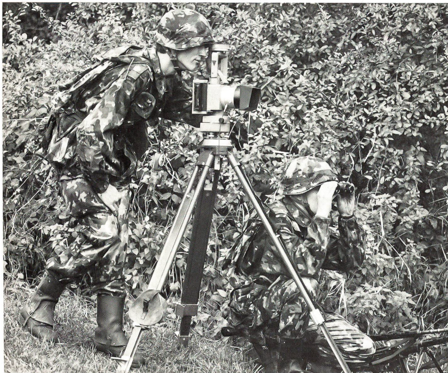
Einsatz einer Fot Patr im Mittelland mit Pano-Kamera APK 70 (Wild)
