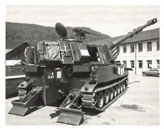
Panzerhaubitze M-109/Erdsporren am Boden.
