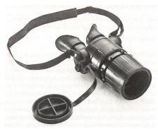
mee ein erstes Los des BIG3-Nachtfernglases ausliefern. Diese passiven Nachtsehgeräte werden in Infanterieeinheiten zur Erkundung und Beobachtung sowie in der Feldartillerie zur Feuerleitung eingesetzt. Das Wild BIG3 ist ein leichtes, kompaktes Gerät mit vorzüglicher Optik. Es kann mit Lithium- oder handelsüblichen Alkalibatterien betrieben werden. Bildverstärkerröhren zweiter oder dritter Generation verschiedener Hersteller lassen sich – auch/nachträglich – einbauen.
