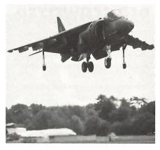
den. Gut sichtbar ist das im Rumpfbug integrierte Sensorfenster der Laser-/Fernsehzielsuch- und Entfernungsmessanlage AN/ASB-19(V) ARBS (Angle Rate Bombing System). (ADLG 10/87: Harrier II GR.5)
