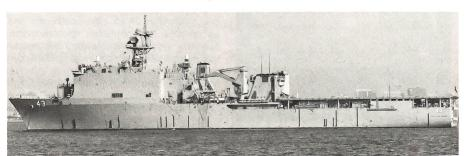
Die «USS Fort McHenry» (LSD-43) in der Bucht von San Diego vor Anker. Dieses amphibische Docklandungsschiff ist die dritte Einheit der neuen «Whidbea Island»-Klasse. Deutlich ist das langgestreckte Helikopterdeck erkennbar (mit Schornstein und Kran), unter welchem sich ein flutbarer Dockraum befindet, der bis zu vier Luftkissenfahrzeuge (LCAC) mit je 50 t Traglast aufzunehmen vermag. Das Schiff kann zudem noch 440 Marineinfanteristen transportieren.
