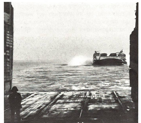
Hier schwebt ein amphibisches Luftkissenfahrzeug LCAC, beladen mit zwei Camions und zwei M-109 155-mm-Haubitzen, auf den Dockraum der «Peleliu» (LHA-5), einem amphibischen Helikopterträger der «Tarawa»-Klasse, zu. Gewaltige Wasserfontänen füllen den Dockraum in jenem Moment, in welchem das Fahrzeug ins Innere gelangt. Präzise Steuerarbeit wird von der 5-Mann-Besatzung der LCAC verlangt.
